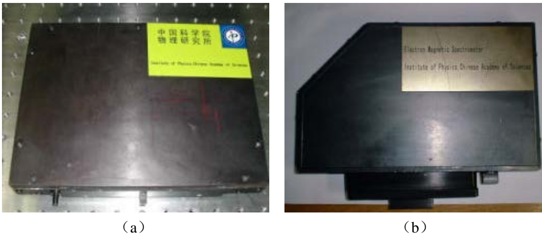
图 3-1 郑志远博士设计的两款电子磁谱仪。(a) 磁场强度为 1000Gs，探测范围为 100keV~2MeV (b) 磁场强度为 420Gs，探测范围为 30keV~500keV [96]
