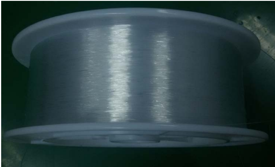
图 3-6 直径为 0.75mm 的 PMMA 塑料光纤
